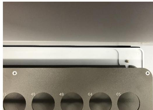
**Abb. 24** und **Abb. 25** Aus den Nasen herausgehobenes Probenrack
