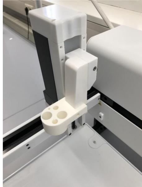
**Abb. 15** und **Abb. 16** Befestigung des Titrationskopfes am Titrationsturm
