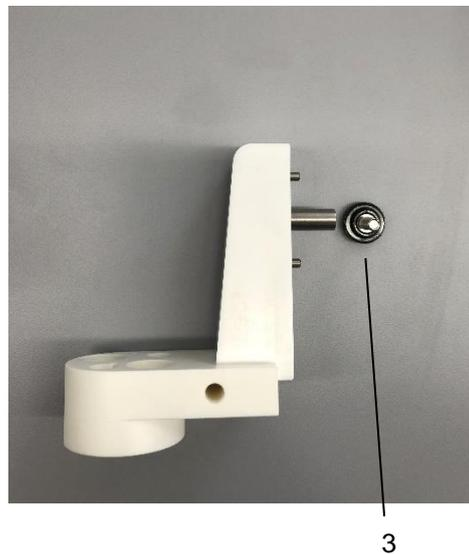
**Abb. 14** Zusammengebauter Titrationskopf TZ 3974
