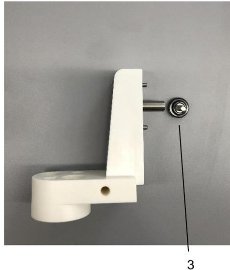
**Fig. 14** Assembled TZ 3974 titration head
