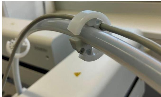
**Abb. 17** An der Stromversorgung mittels Kabelführung befestigtes Kabel.
